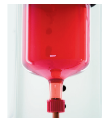
PremiumHeizöl ecotherm in gealtertem Zustand
