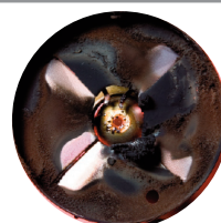
Stauscheibe mit Standard-Heizöl
