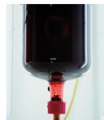
Standard-Heizöl in gealtertem Zustand
